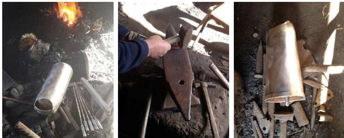
Tres intres do proceso de embadalado das chocas na forxa de Ramón Morgade, ferreiro de Vilameá (Laza).
